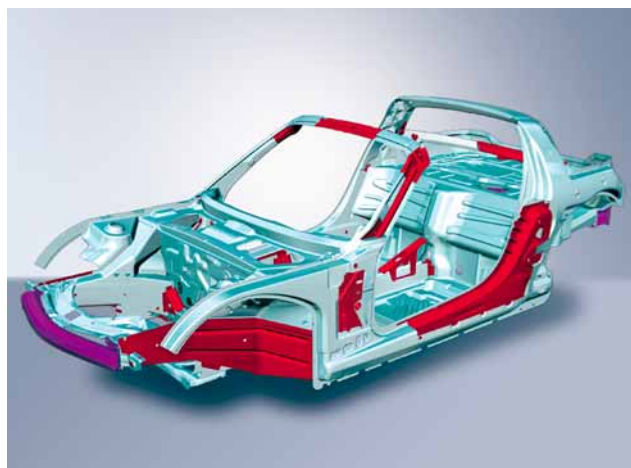
smart roadster: Aufbau TRIDION-Zelle mit Strukturverstärkungen (rot)
