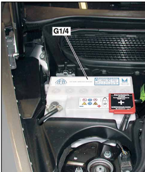
G1/4 Starterbatterie im Motorraum rechts
