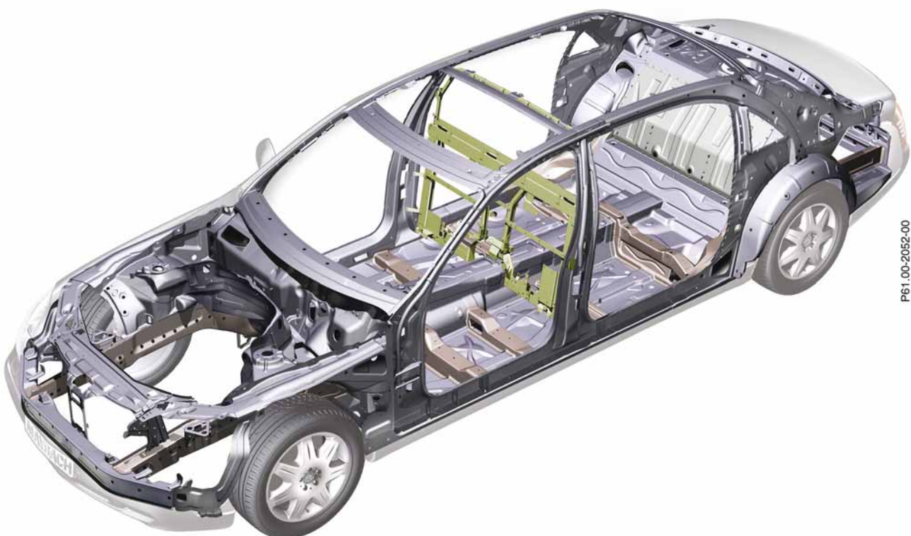
Rohbau Maybach 62 mit Trennwand (Typ 240)
