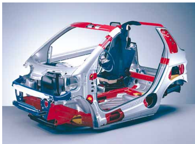
smart fortwo cabrio: Aufbau TRIDION-Zelle mit Strukturverstärkungen (rot)
